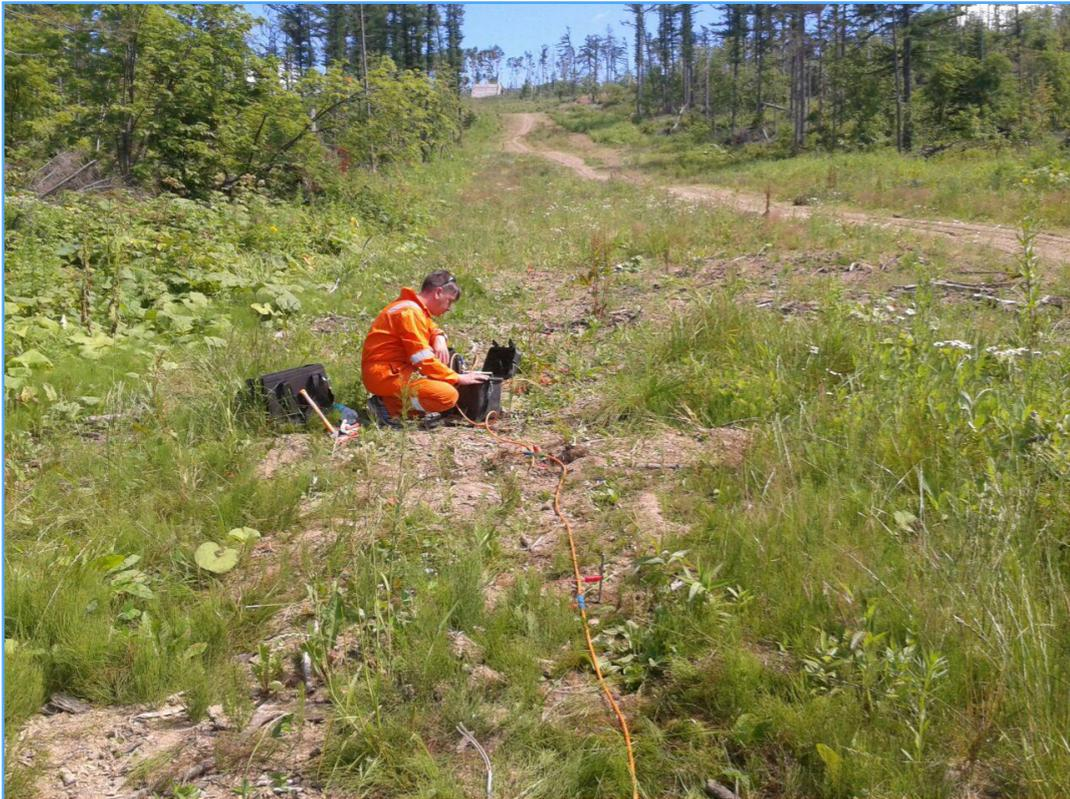
Определение глубины залегания кровли скальных грунтов
