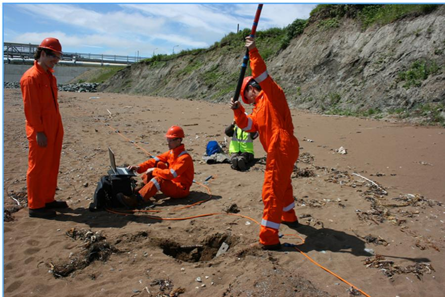
Определение глубины залегания уровней подземных вод, водоупоров, гидрогеологических параметров грунтов и водоносных горизонтов
